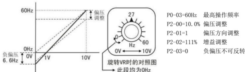
范例七：此范例是所有电位器应用的集大成，加上正转与反转区的应用可以很容易的与系统结合做各种复杂的应用，当此应用设定外部端子的正反转指令将自动失效，需特别注意。
