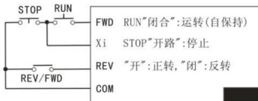
三线式模式二：P0-35=d01（X1 设定为 FWD）、P0-36=d02（X2 设定为 REV）、P1-19=d03、端子 Xi (i=3、4、5) 对应参数（P0-37、P0-38、P0-39）设定成 d03。
