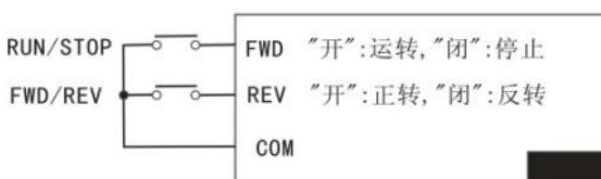
三线式模式一：P0-35=d01 (X1 设定为 FWD)、P0-36=d02 (X2 设定为 REV)、P1-19=d02、端子 Xi (i=3、4、5) 对应参数 (P0-37、P0-38、P0-39) 设定成 d03。
