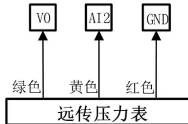
(2) 压力传感器：工作电压 10~24V，输出 4 ~20mA, 接线方式如下图所示：
