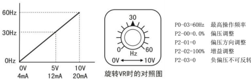
范例二：此范例为业界用来操作变频器时，希望设定的电位器在旋转至最左处时为 10Hz，也就是当启动时变频器最低必需输出 10Hz，其他的频率再由业者自行调整。由上图可看出此时外部的输入的电压或电流信号与设定频率的关系已从 0~10V (4~20mA) 对应 0~60Hz 的关系，转变成 0~8.33V (4~13.33mA) 对应 0~60Hz。所以，电位器的中心点变成 40Hz 且在电位器后段的区域均为 60Hz。若要使电位器后段的区域均能操作，请接着参考范例三。
