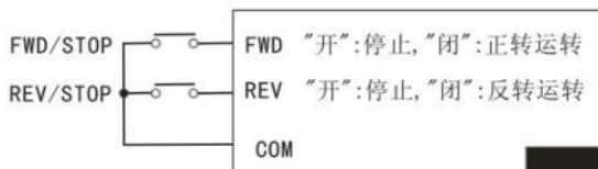
二线式模式二：P0-35=d01 (X1 设定为 FWD)、P0-36=d02 (X2 设定为 REV)、P1-19=d01
