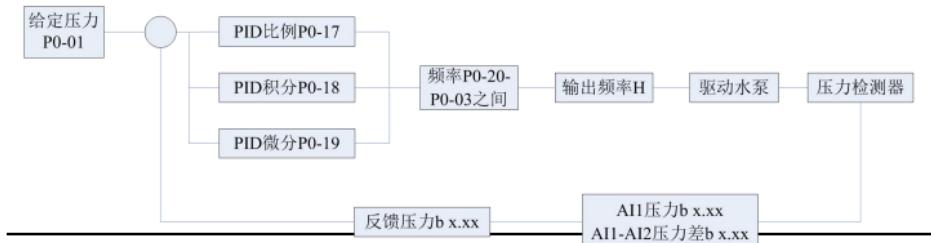
P0-17 比例越大，压力响应越快，P0-18 积分越小，压力响应越快，振荡越大，P0-19 微分越大，压力变化差响应越快。
