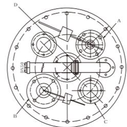
A: 重锤式排气阀Pressure Relief Valve (ZP45X-1.5P)
